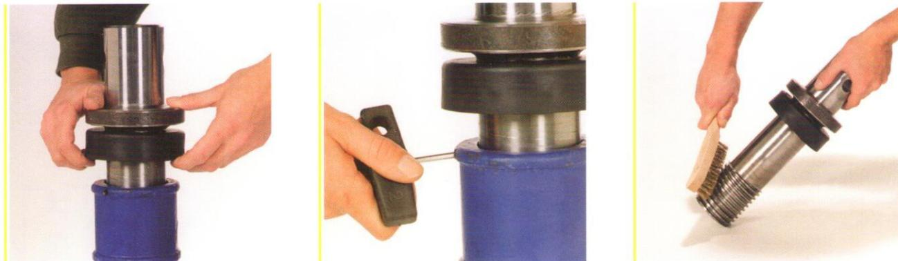
Einmal jährlich Dichtungsring abziehen, Sicherungsschraube lösen, Gewindeteil ganz herausdrehen, reinigen und nachfetten. Fertig! So ist die Spindel auch nach vielen Tiefbauprojekten noch drehfreudig.
