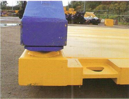
Die vorbereiteten Platten durch Verschrauben der Rollenschlitten miteinander verbinden.
